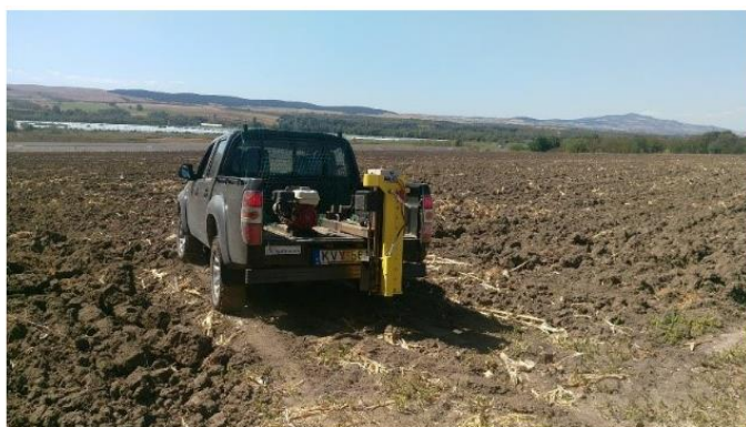
Kép: Automatikus talajmintavétel (Forrás: SOMOCO Project)
